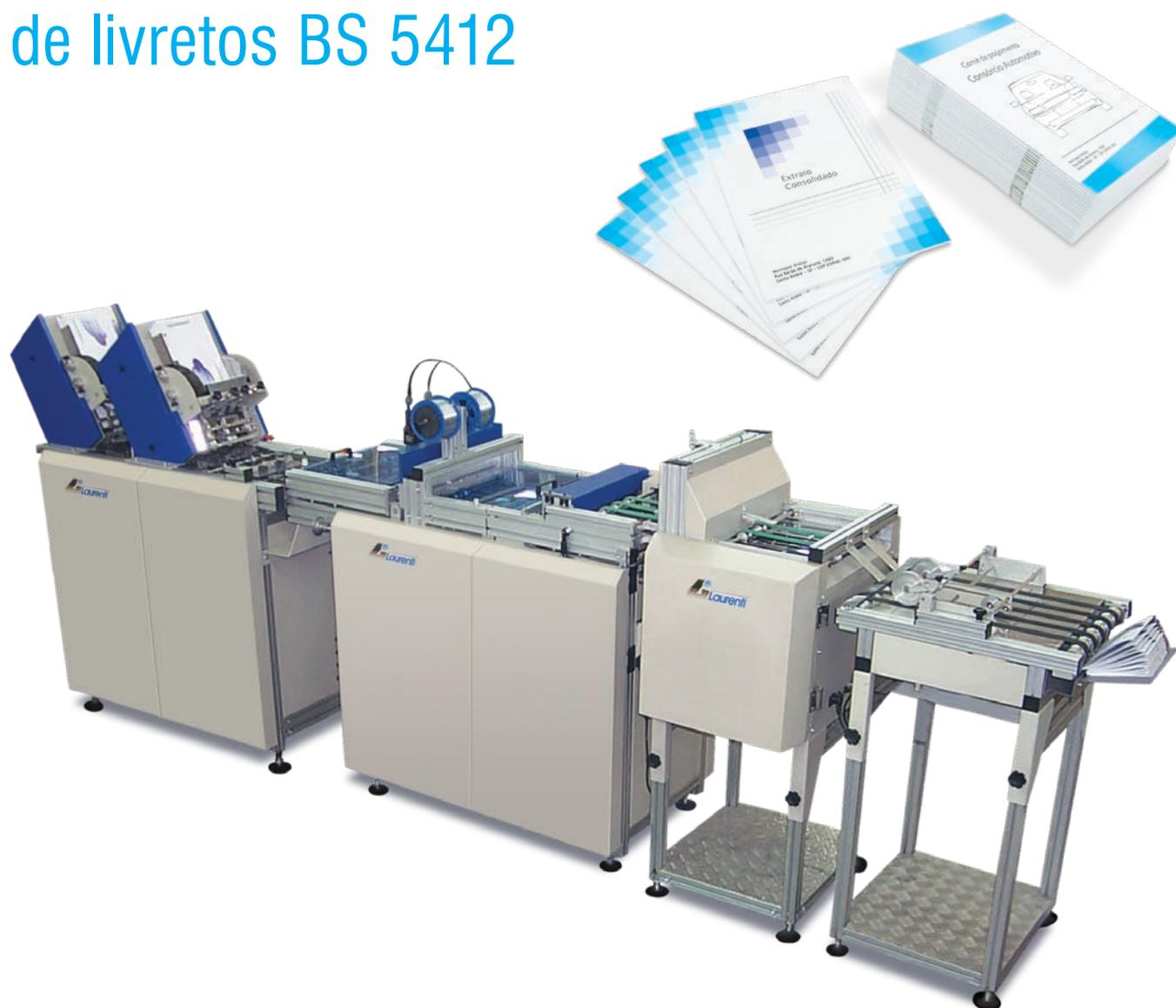
O sistema BS 5412 foi desenvolvido especialmente para fabricação de livretos. Projetado em concepção modular, divide-se nos módulos de alimentação de folhas, agrupamento e grampeamento, dobra, refile e esteira de empilhamento horizontal. O módulo de alimentação possui dois canais de inserção de folhas planas, com sistema de leitura de código de barras que garante a montagem do livreto na seqüência correta.
